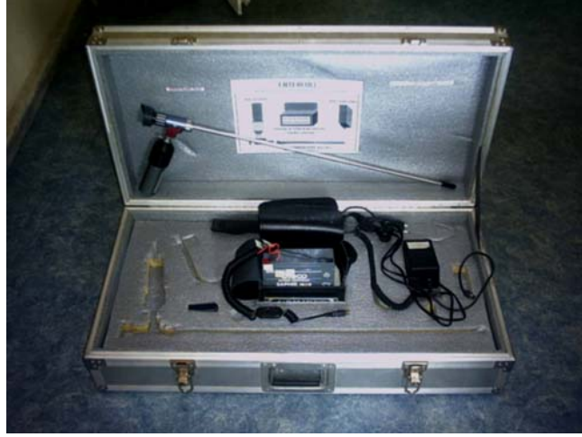
ENTERCOM 2000 Enkaz altı Canlı arama ve görüntüleme skobu
