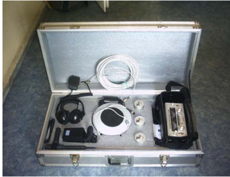
ENTERCOM 2000 Enkaz altı Canlı arama ve dinleme dedektörü
